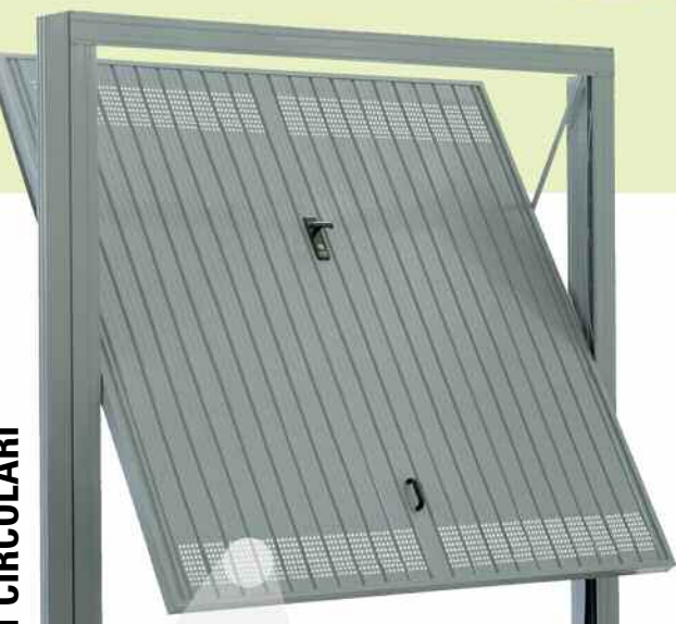
Questo modello con fori circolari diametro 9 mm. non consente la stessa superficie di aerazione del modello con fori rettangolari ma gode di una gradevole estetica.
